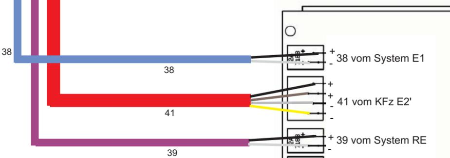
**Der Laderegler kann an die Lichtsteuersysteme ab 2009 Angeschlossen werden. Für ältere Systeme muss der Laderegler TLR EL326 6122120008 verwendet werden.**
